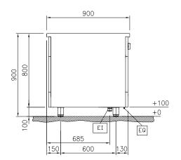
Electrical inlet (power) EQ Equipotential screw
